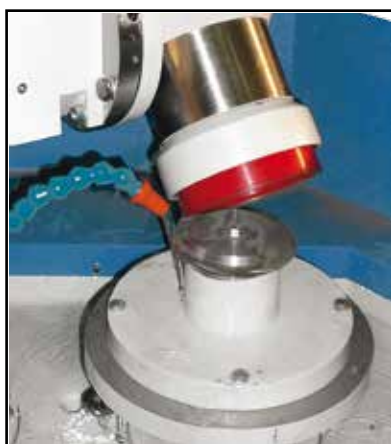
Flangia per tavola rotante Flange for standard rotating table Фланец для вращающегося стола
