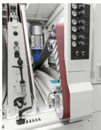
Выдвижная внутренняя поперечно-шлифовальная ленточная группа с длиной абразивной ленты 5000 мм.
