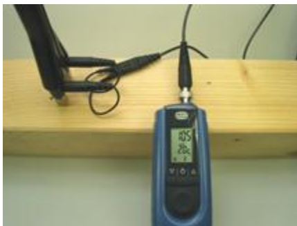
Рисунок 4-1 Измерение поперек направления волокон при помощи М 20
