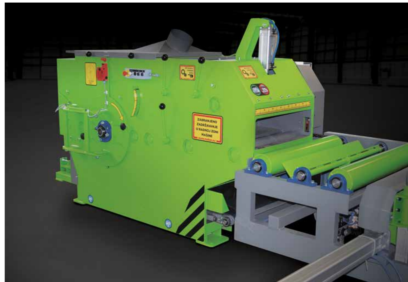
Одноосные, тяжелые многопильные станки. Возможна простая или автоматическая подача.
