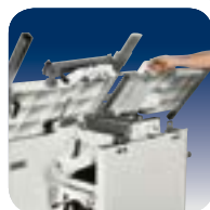
Раскрытие фуговальных столов максимальная доступность
